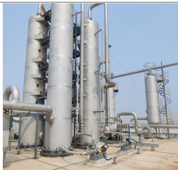
酚醛树脂、脲醛树脂废气处理设施（二级洗气塔）
