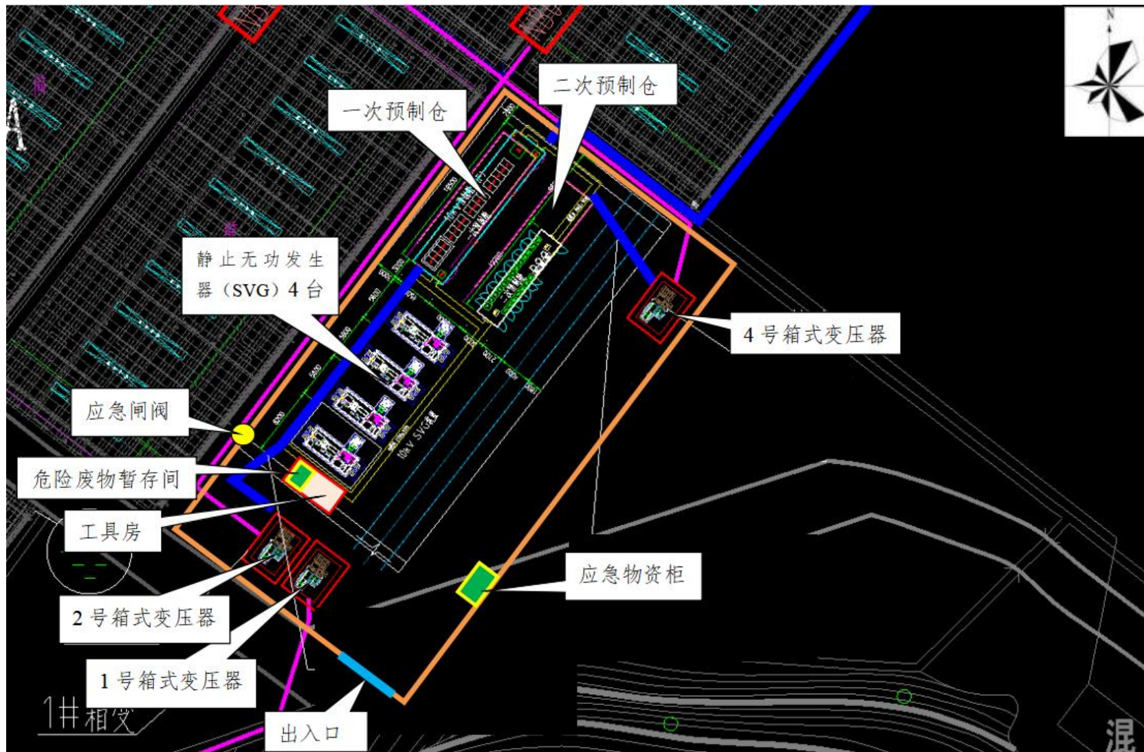
附图 6 项目变电区 2#及开关站平面布置图
