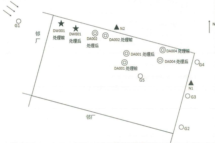
注: ○无组织废气检测点、▲噪声检测点、◎有组织废气检测点、★废水检测点
