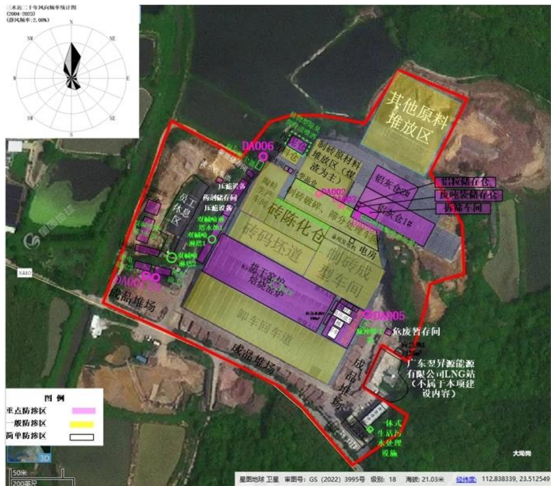
图 4.1-9 项目地下水分区防渗图
