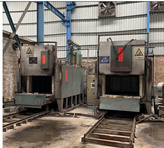
电炉退火炉
