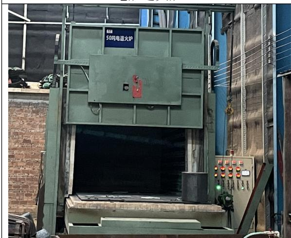
电炉退火炉
