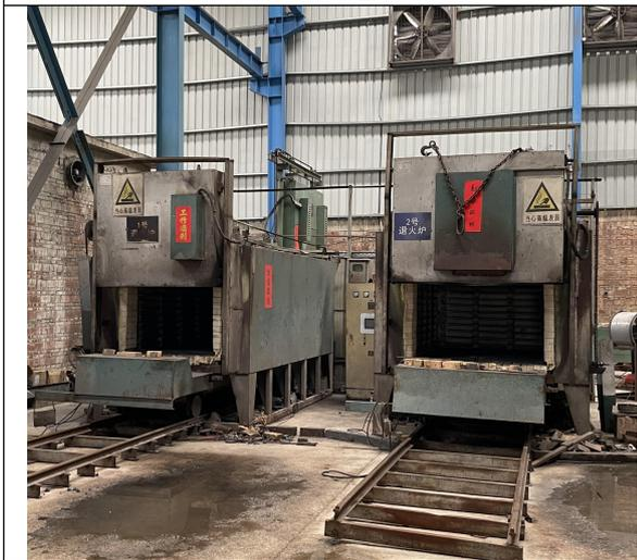
电炉退火炉
