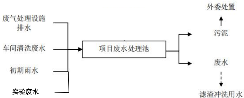
图 4-1 环保车间生产废水处理工艺流程
