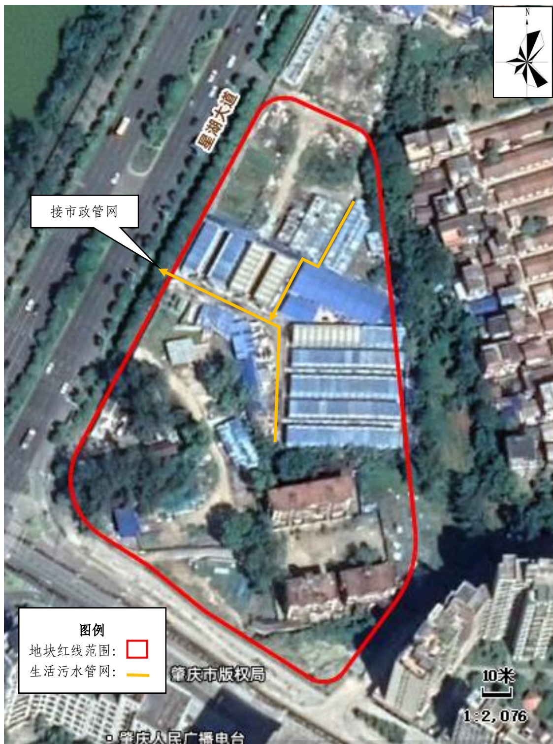
图 3.3-1 临时板房的平面布置情况及污水管网图
