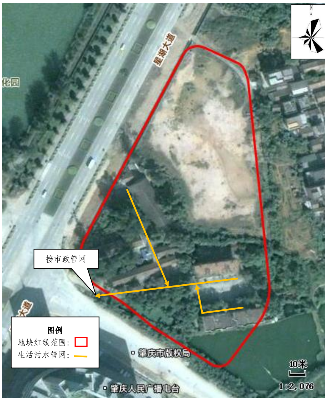
图 3.3-2 员工宿舍的平面布置情况及污水管网图
