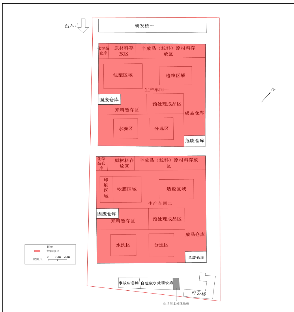
图 8.2-4 项目地下水分区防渗示意图
